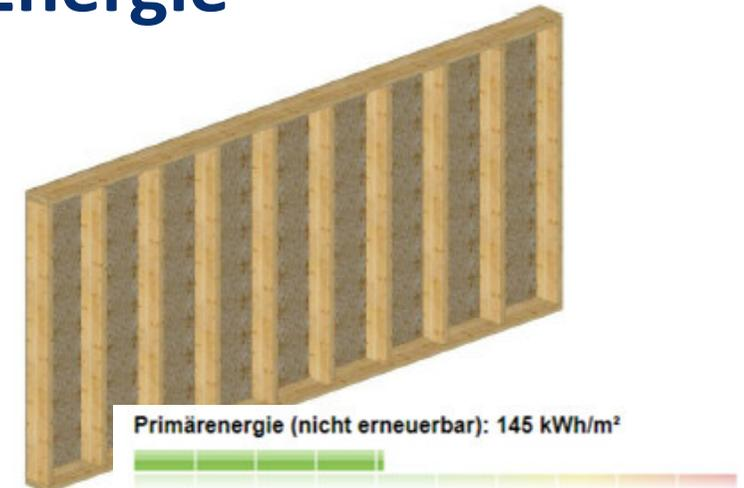
Abbildung 12: Tragkonstruktion Holzrahmenbau
