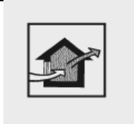
Die Luftdichtheitsschicht hat die Aufgabe, die Durchströmung (**Konvektion**) der Gebäudehülle zu verhindern
